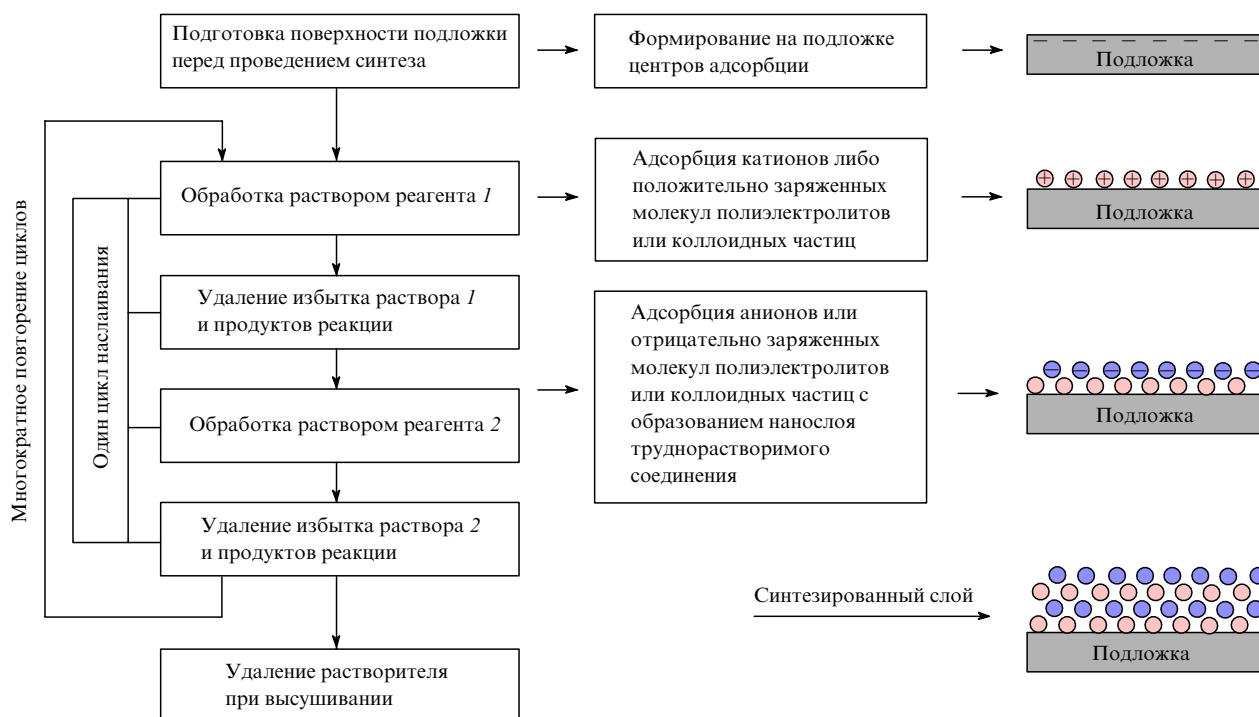
Рис. 1. Последовательность обработки подложки реагентами при ПХС.
